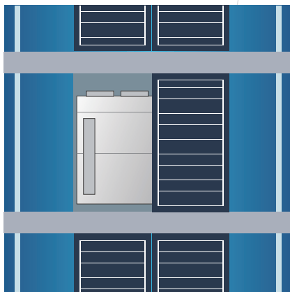
Багаторівневе встановлення зовнішніх блоків легко вирішує проблему розсіювання тепла
